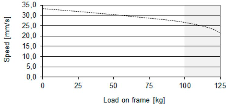
Ovenstående kurve gælder for en centralt placeret belastning og er kun gyldig i forbindelse med duty cycle: 10% ved 50% af den maksimale belastning eller maks. 2 min. uafbrudt. Ovnævnte specifikationer kan variere afhængigt af lokale temperaturer, luftfugtighed og netspænding.
